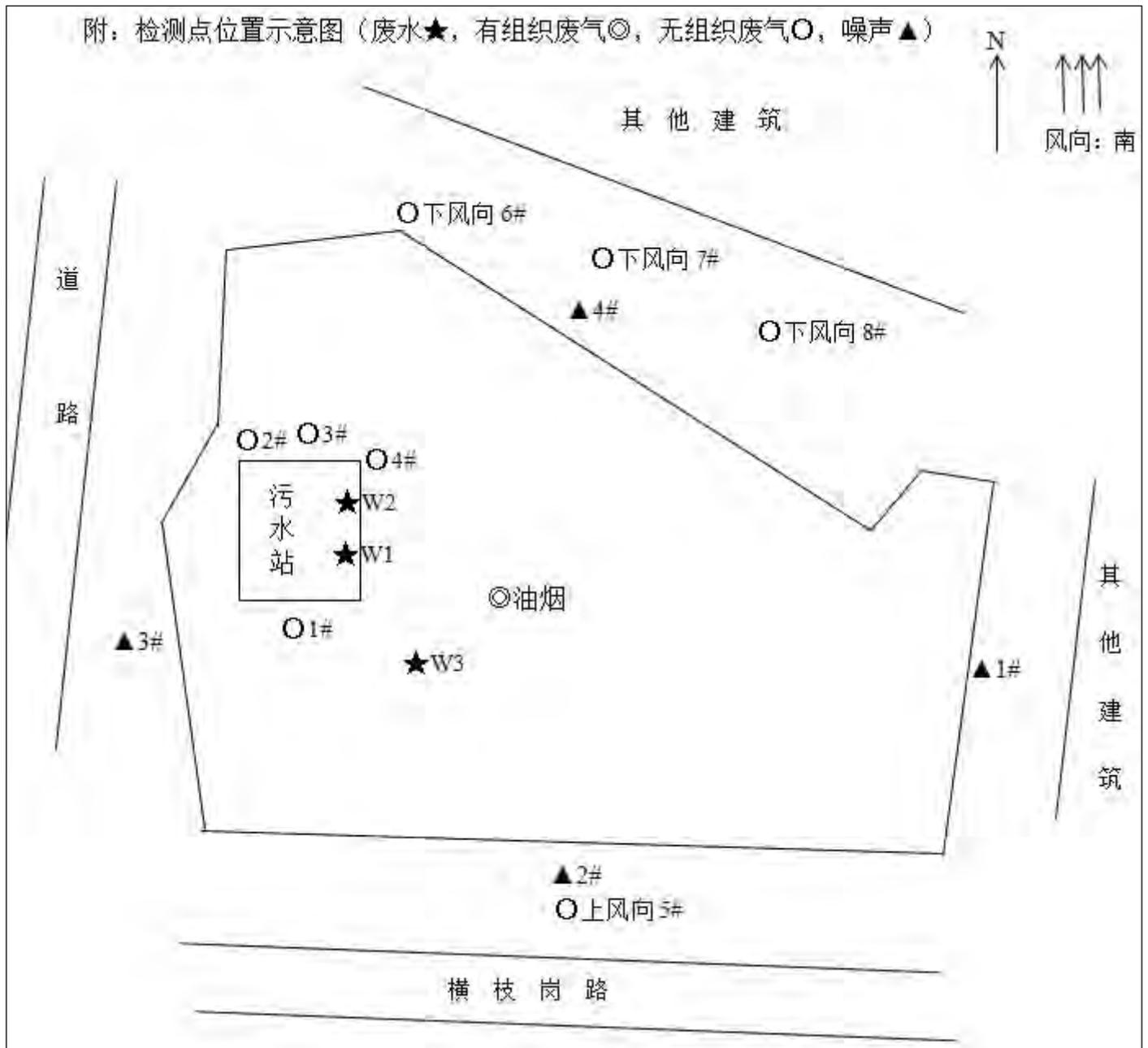
图6-1 项目验收监测点位布设示意图
