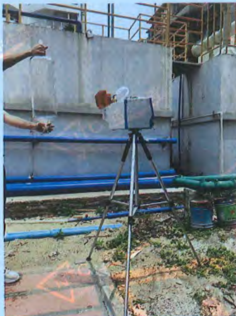
污水处理站边界无组织下风向监控点 2#
